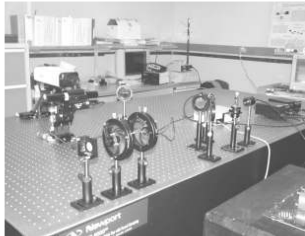
Fig. 3 Arreglo experimental de Interferómetro Michelson en Cuadratura
